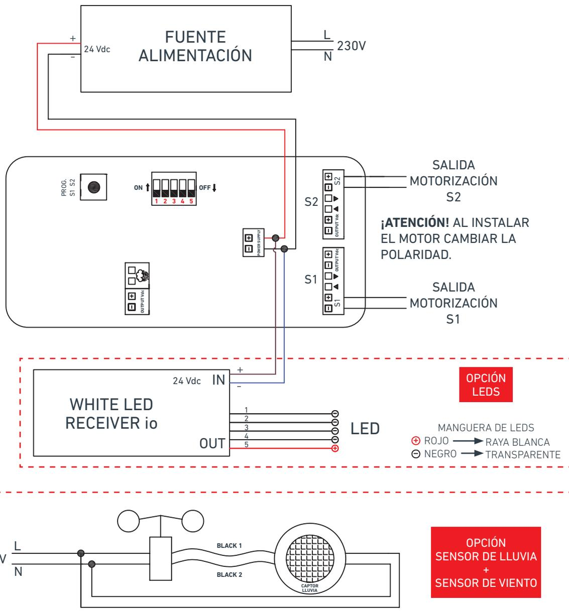
Central para pérgola sistema io, con leds, y sensor de viento.
