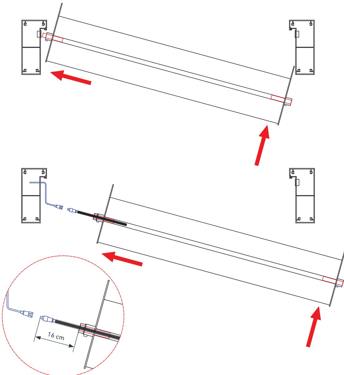
Instalar las lamas inclinándolas con las aletas de los testeros hacia abajo, introduciendo en primer lugar el eje fijo (izquierda) y posteriormente, el eje móvil (derecha).
