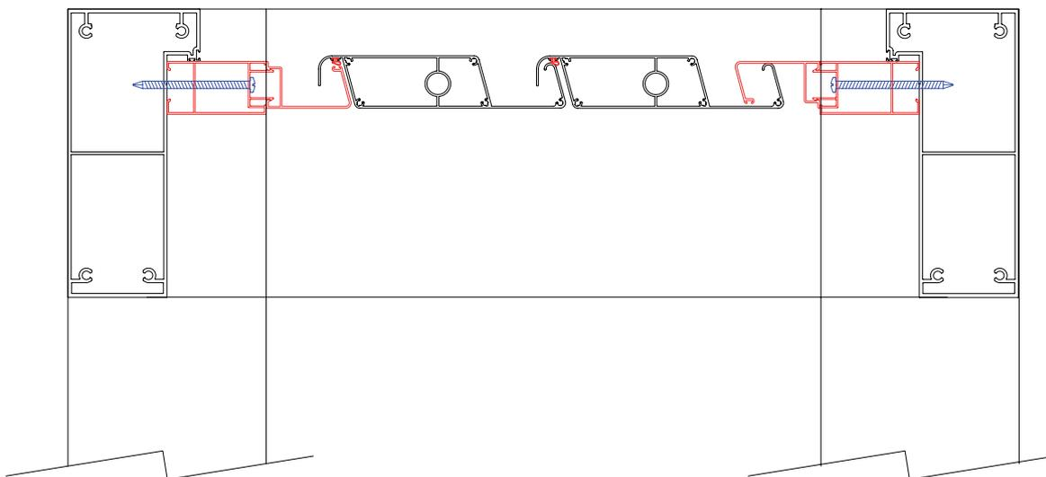
Comprobar que todos los orificios del perfil "U" coinciden con los mecanizados de M6 de la viga. Si todos coinciden, aplicar sellador entre el perfil "U" y la viga, después atornillar los perfiles por medio de los tornillos USL (ISO7380) A2 M6x16.
