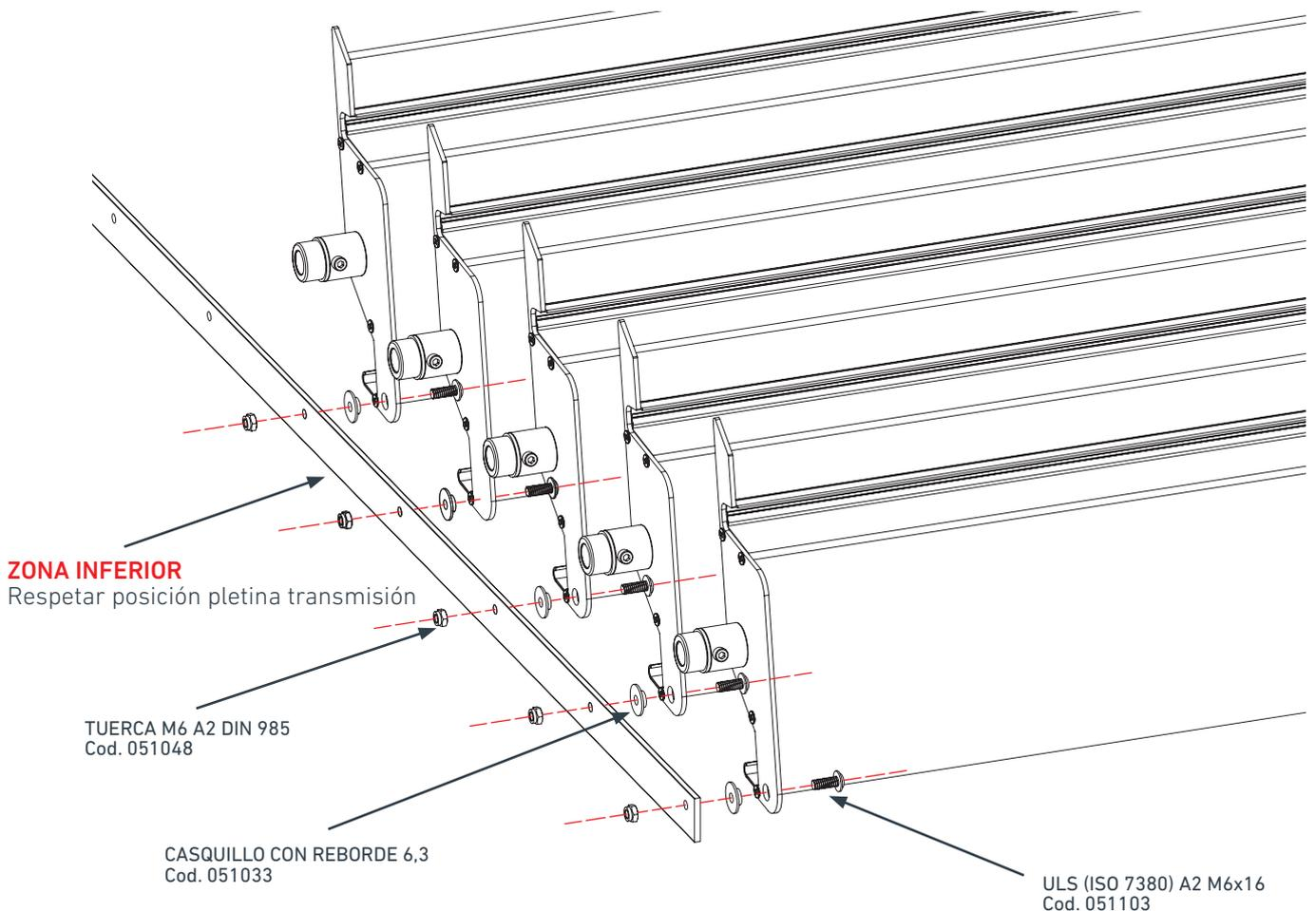
**IMPORTANTE:** Al ir instalando la pletina a las lamas, no apretar demasiado las tuercas de los tornillos, que queden ajustadas pero sin apretar, para que la pletina realice los movimientos de apertura y cierre manualmente sin ningún tipo de fricción.
