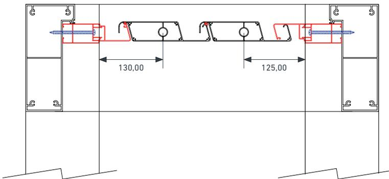
Realizar el gotero en los extremos de ambos colectores, antes de continuar con la instalación. (Utilizar un martillo y un destornillador plano).
