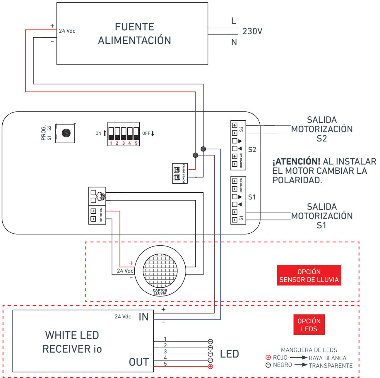
Central para pérgola sistema io, con leds, sensor de lluvia y de viento.
